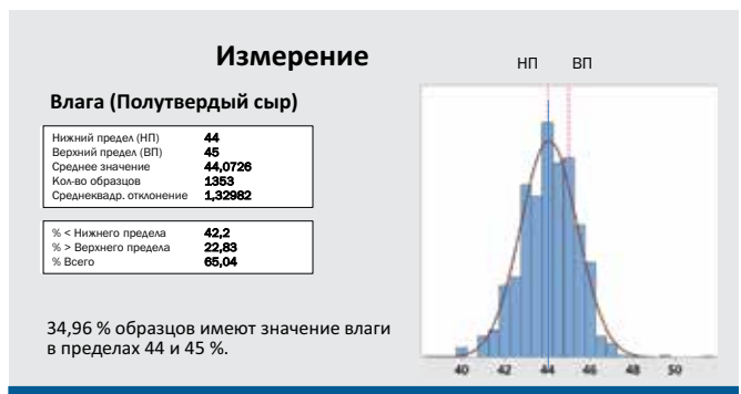
Рис. 5. Пример гистограммы для измерения текущей ситуации (в данном примере – содержание влаги в полутвердом сыре)
